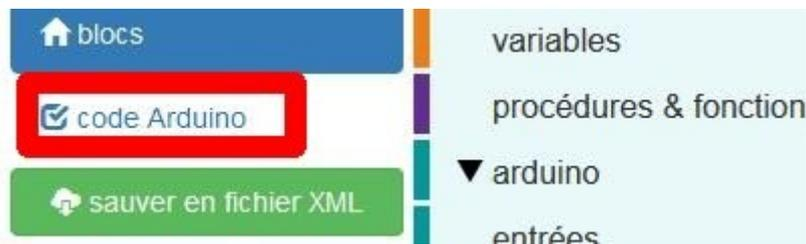
Noter ici que l'on peut passer facilement des blocs au code et inversement avec les deux « boutons » « code arduino » et « blocs ».
